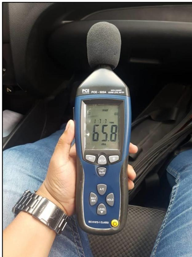
Foto 4.- Sonómetro integrador PCE 322 para obtener los niveles de Presión Sonora.
