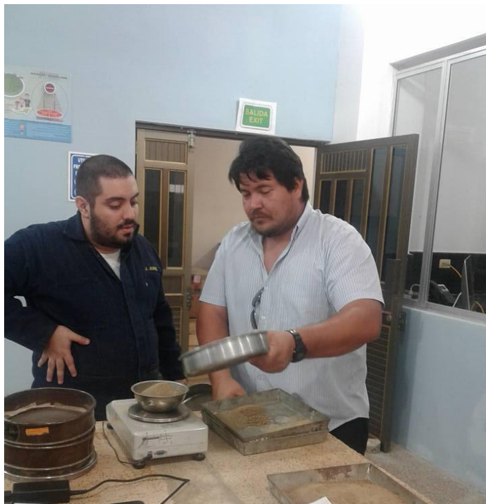
Foto 2: Pesado del material retenido en los tamices
