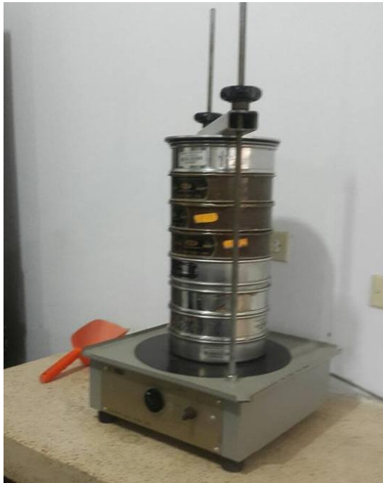
Foto 1: Tamizado de material de la primera calicata
