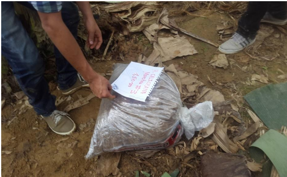
Foto 4: cada muestra recogida se la coloco en fundas plásticas para su traslado al laboratorio.
