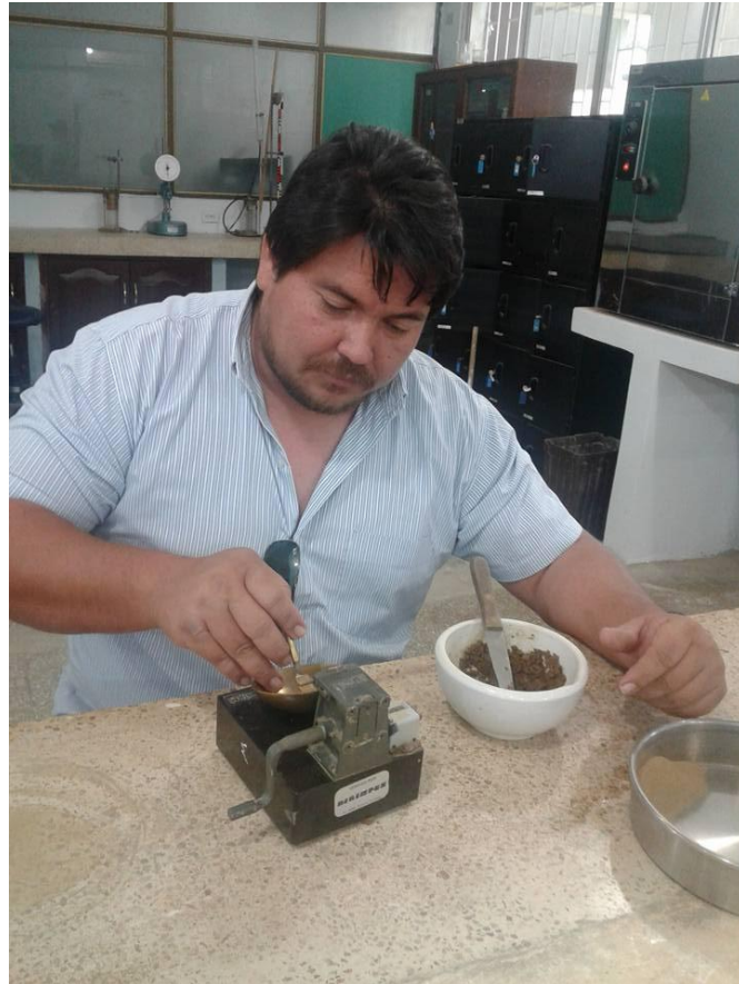
Foto 3: Determinación del límite líquido con la copa de casa grande de una muestra del sitio La Hacienda Calichana.
