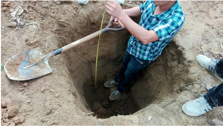
FOTO: 3. Recolección de muestra a 1,50 cm para las pruebas en laboratorio.
