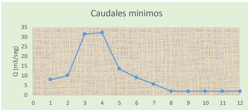
Figura 5. Caudales mínimos registrados por la estación H0591
