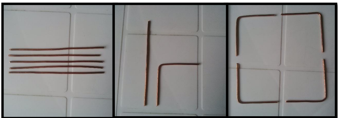
Ilustración 2: Cable sólido #14 en formas
