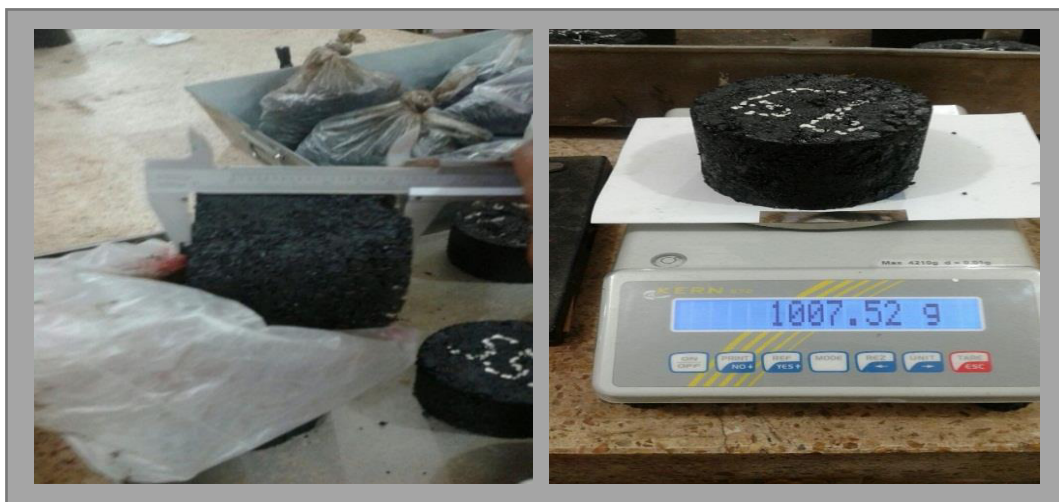
Figura 3.- Determinación Del Peso Específico Bulk De Las Briquetas Compactadas
