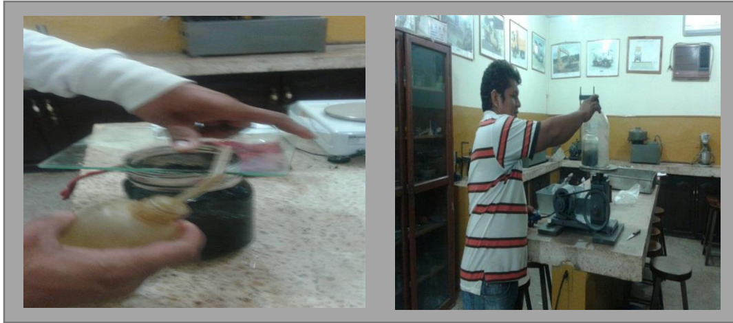
Figura 5.- Determinación Del Peso Específico Máximo De Una Mezcla Asfáltica (Rice)
