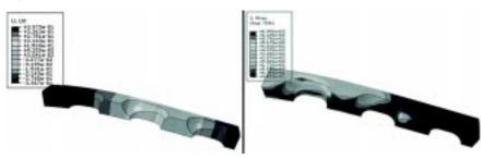
Fig. 10. Tensiones de Von Mises (MPa) y Deformaciones (mm).
