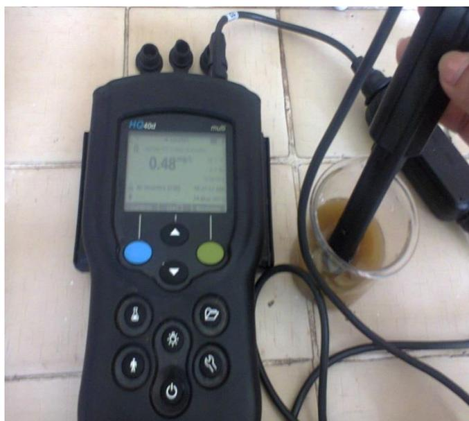
**Anexo 10.** Monitoreo de conductividad eléctrica durante el proceso de digestión anaerobia
