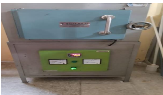
Determinación de materia orgánica mediante calcinación en mufla.
