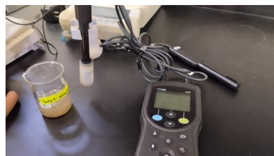
Determinación de pH y conductividad eléctrica mediante un medidor multiparamétrico HQ40D.
