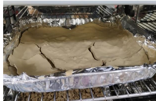
Secado de las muestras en una estufa a una temperatura de 40°C durante 24 horas.
