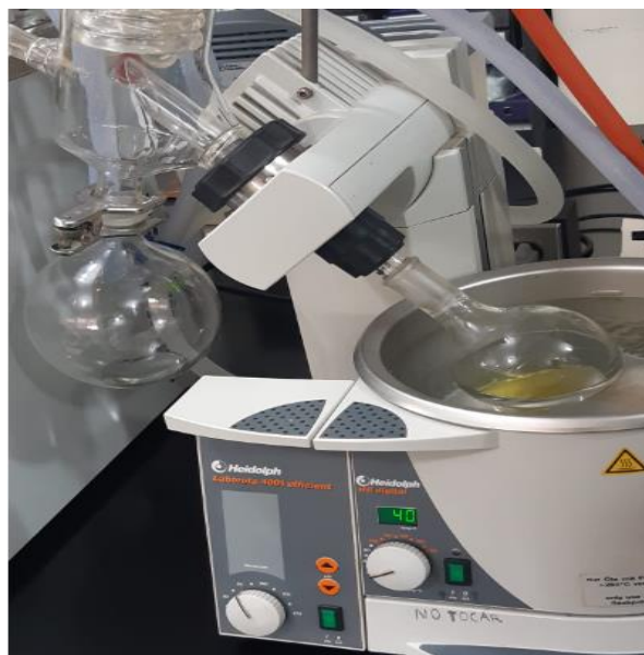
Anexo #11 Muestra sometida al rotoevaporador para eliminar el solvente
