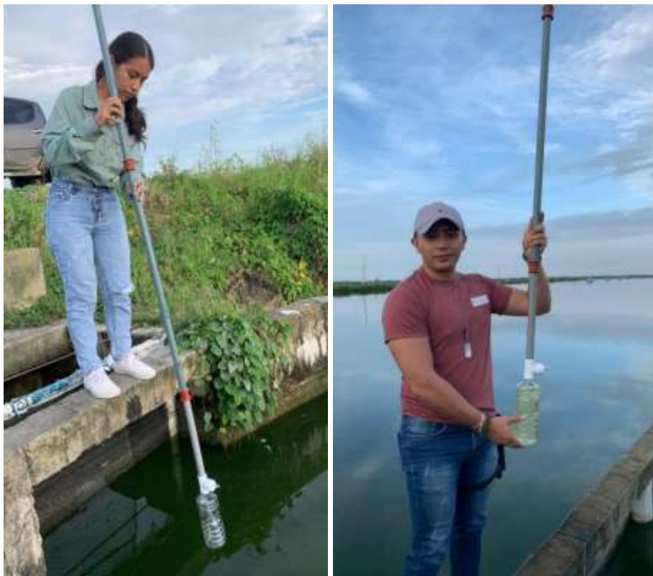
Anexo 2. Toma de muestras de agua con el uso del tubo muestreador fabricado por los estudiantes
