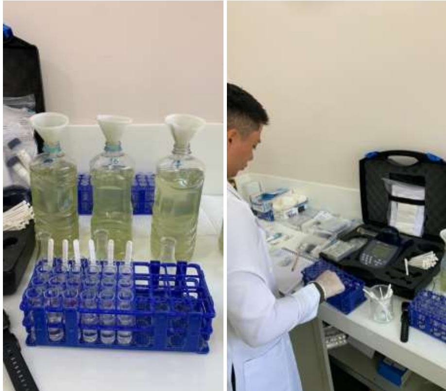
Anexo 5. Análisis de nutrientes (N y P) mediante el uso del fotómetro YSI-9500
