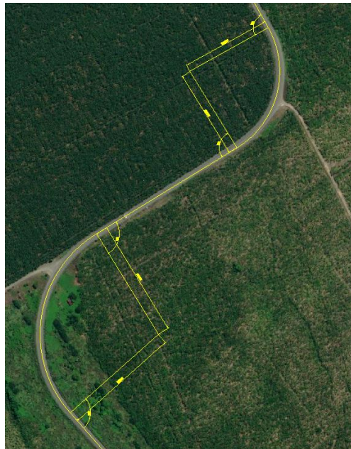
Ilustración 7 Radios de curvas medidos en AutoCAD
