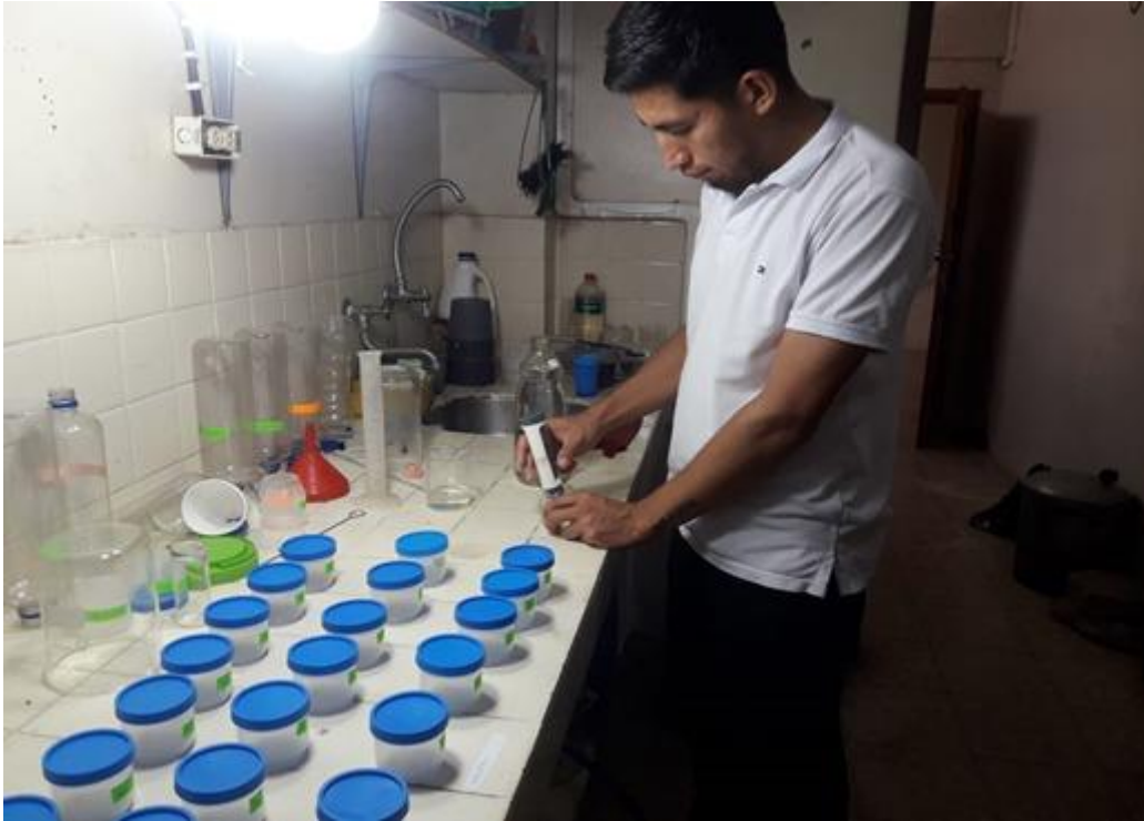
Ilustración 7: Medición de pH en unidades experimentales.
