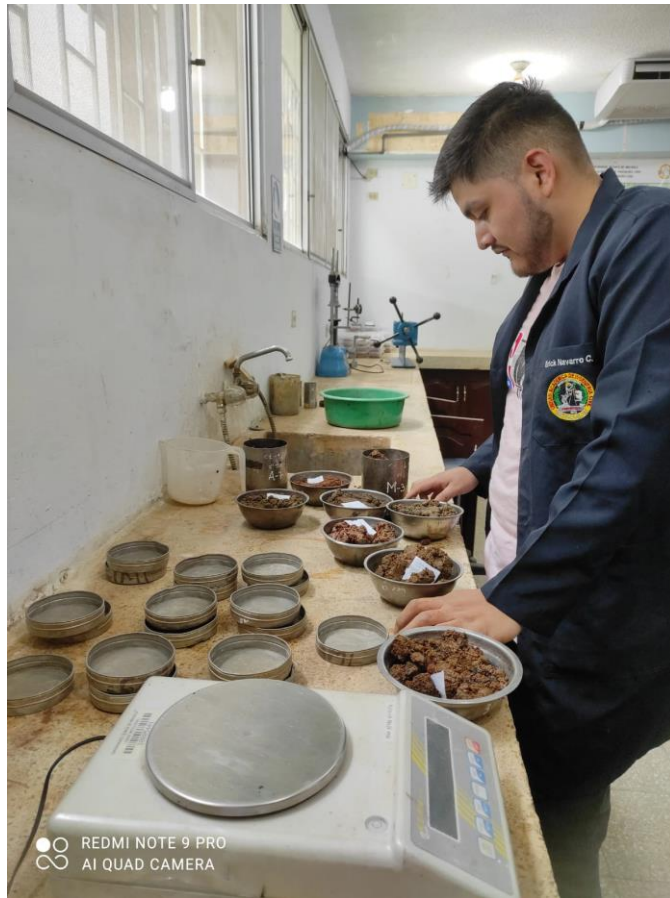
Ilustración 41 Ensayo de contenido de humedad
