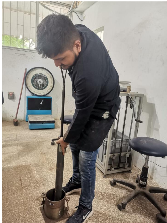
Ilustración 46 Ensayo Proctor modificado
