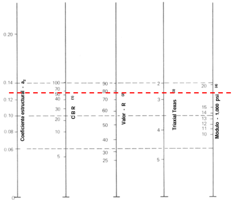
Ilustración 7 Variación en el coeficiente estructural de la capa de subbase Fuente: Manual Centroamericano para Diseño de Pavimentos
