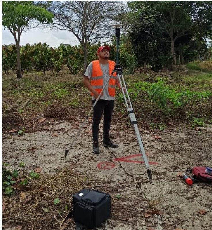
Ilustración 33 Ubicación de la base y configuración de equipo RTK
