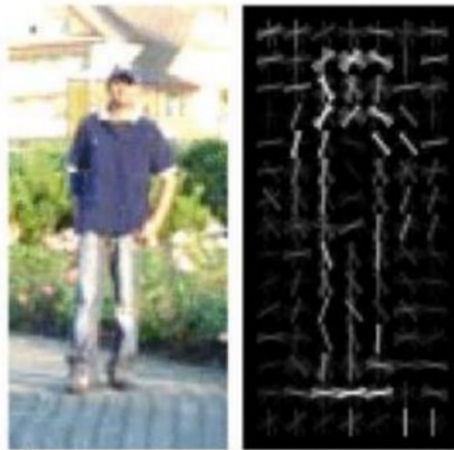
Figura 23. Aplicación de los descriptores HOG. Izquierda: Imagen bajo test dividida en varias celdas. Derecha: Visualización de los descriptores HOG sobre la imagen.
