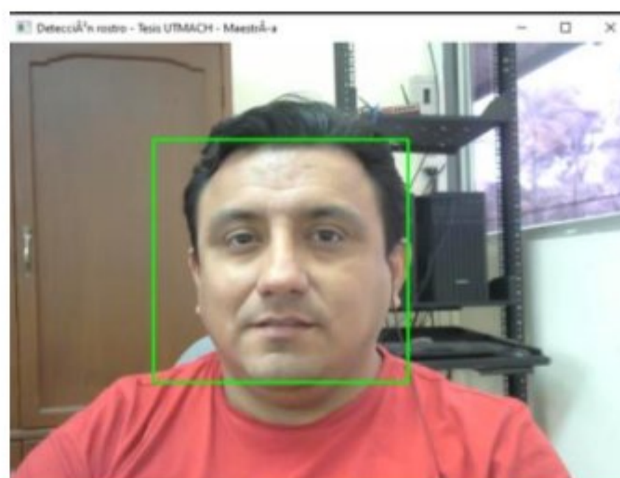
Figura 39. Resultado de la detección de rostro usando EigenFace Fuente: Autor.
