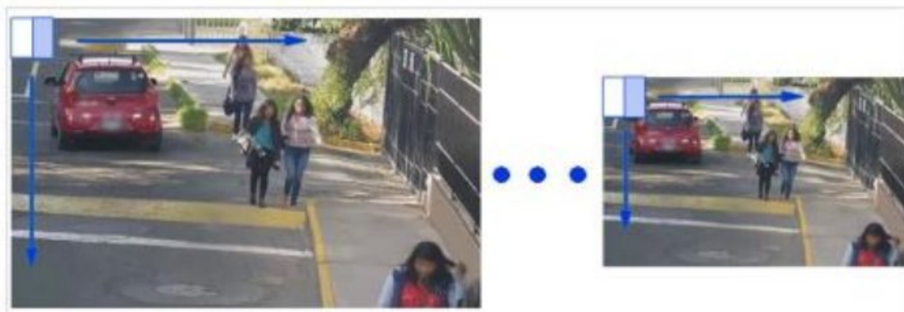
Figura 10. Ejemplo de la aplicación de los kernels convolucionales a través de la imagen y su aplicación en múltiples escalas
