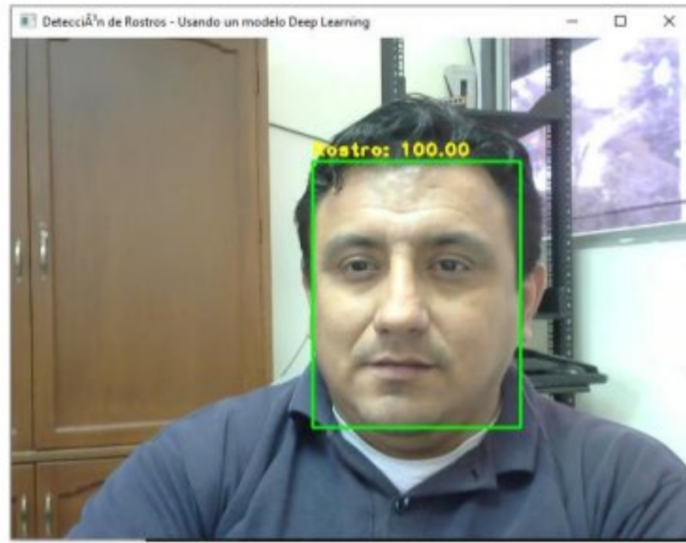
Figura 44. Resultado de la detección de rostro usando Código Framework: Caffemodel
