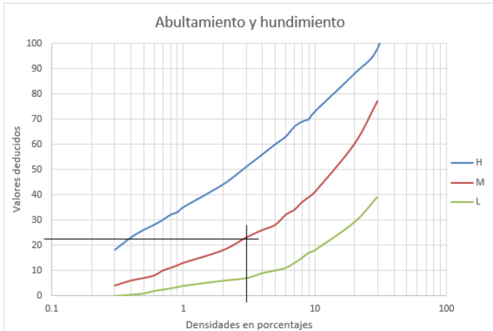
Ilustración 20 Valor deducido de Abultamiento y hundimiento en el Tramo 1
