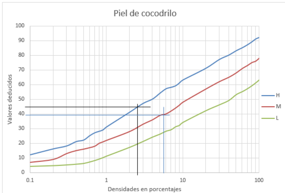
Ilustración 18 Valor deducido de Piel de cocodrilo en Tramo 1
