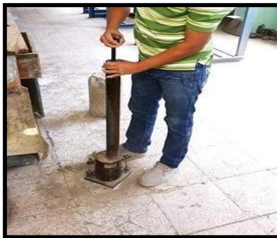
Anexo 3: Compactando la muestra en el ensayo de Proctor.
