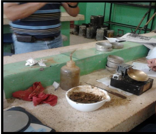
Anexo 2: Realizando el ensayo de contenido de humedad
