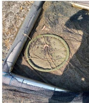
**Anexo G** Medición de turbidez con el disco secchi
