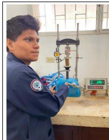
*Ilustración 8. Muestra colocada en la maquina de compresión simple*
