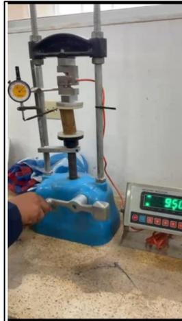
*Ilustración 9. Muestra colocada en la maquina de compresión simple*
