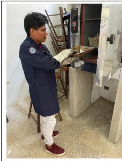
*Ilustración 12. Muestra colocada en horno, para retirar después de 24 horas*
