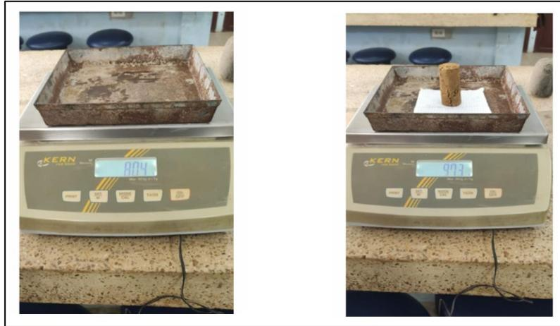
*Ilustración 11. Muestra pesada para calculo de % de humedad*
