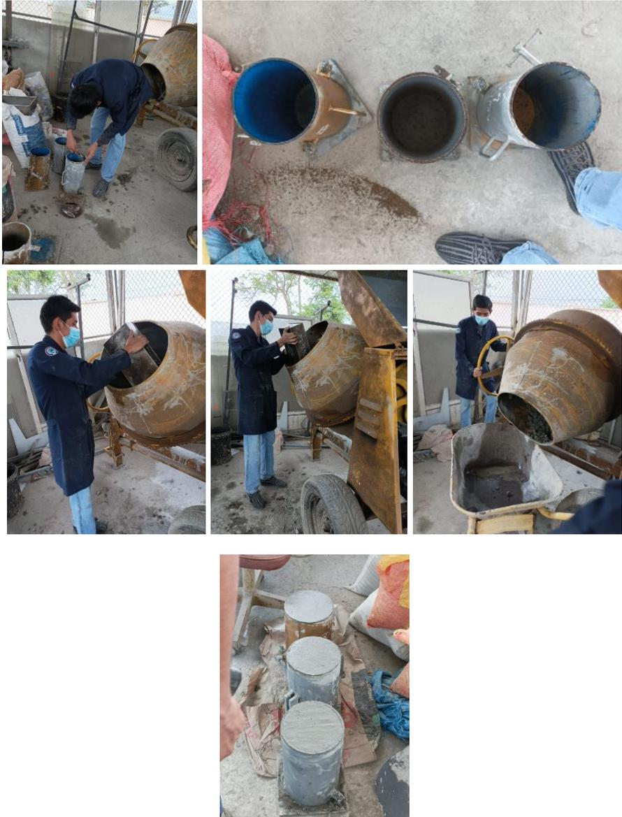
*Anexos II. Preparación y Vaciado del Hormigón Reciclado*
