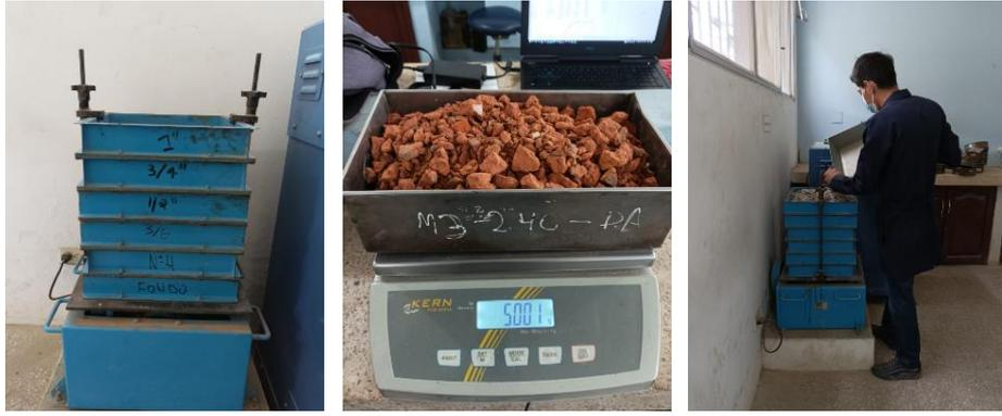
*Anexos 9. Granulometría de los Escombros (Hormigón, Ladrillo y Bloque)*
