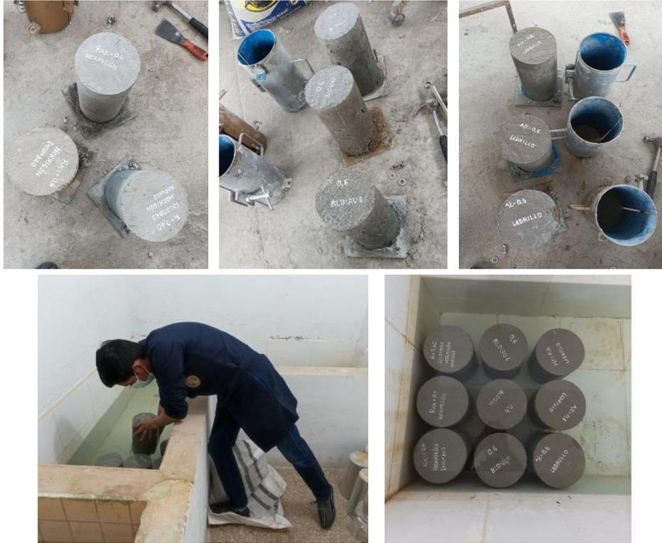
*Anexos 12. Desencofrado y Curado de los Especímenes*
