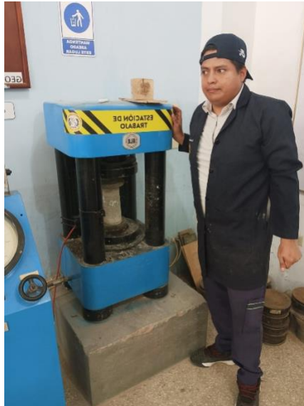
Ensayo a compresión del cilindro a los 14 días
