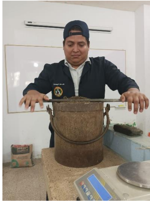
Ilustración 14: Enrasado del material
