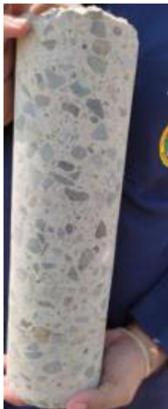
Cilindro o Núcleo de hormigón
