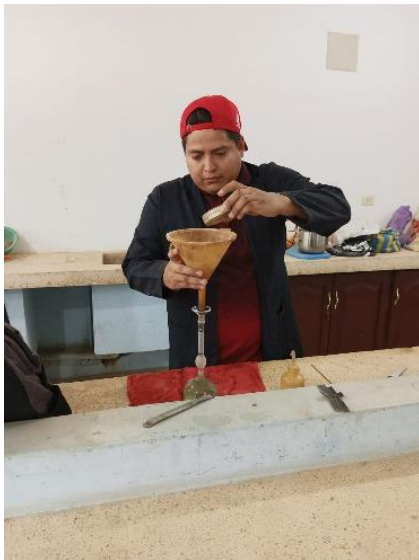
Colocación de la gasolina en el Chatelier.
