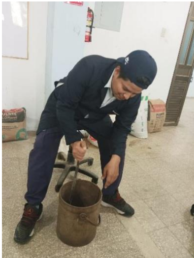
Ilustración 15: Varillado del material cada tercio
