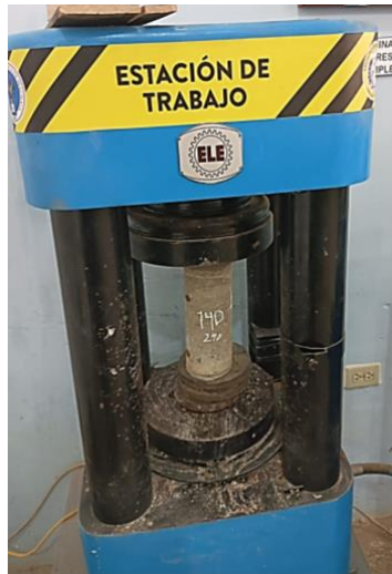
Ensayo a compresión del cilindro a los 14 días
