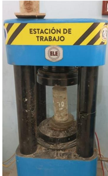
Ensayo a compresión del cilindro a los 7 días
