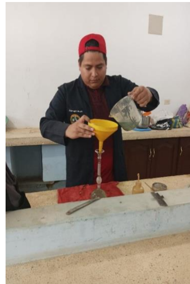
Colocación del cemento en el Chatelier.
