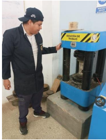
Ensayo a compresión del cilindro a los 7 días
