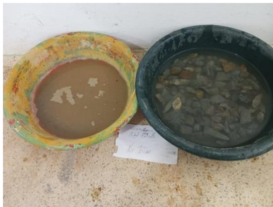
Ilustración 9: Gravedad específica y absorción de los agregados
