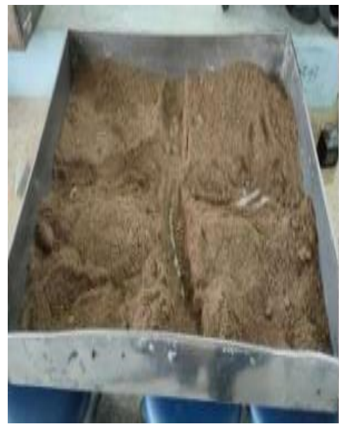
Ilustración 3: Cuarteo de las muestras
