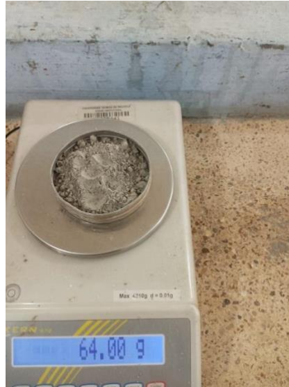
Ilustración 16: Peso del cemento
