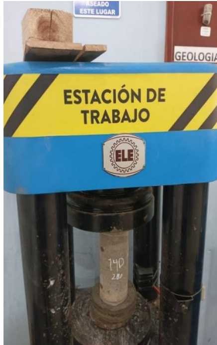
Ensayo a compresión del cilindro a los 14 días
