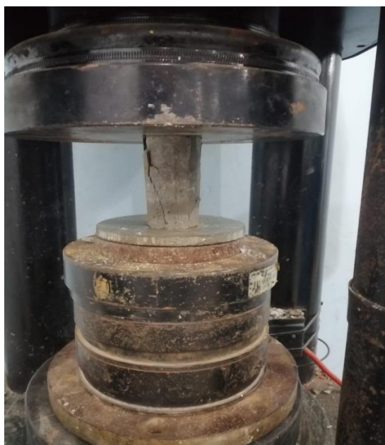
Rotura de cilindro
