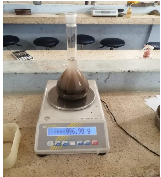
Peso de matraz + agua + muestra sss
