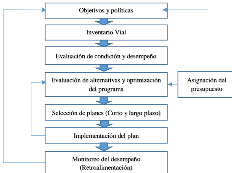
Diagrama de un Sistema de Gestión de Infraestructura Vial
