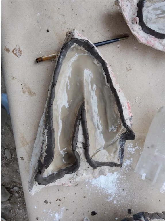
Imagen 10 aplicación de la resina para molde
