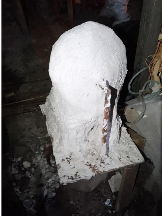
Imagen 8 encofrado con yeso
