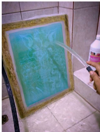
Imagen 30. Lavado de la pantalla serigráfica con el diseño (2022) Fuente: Autores
