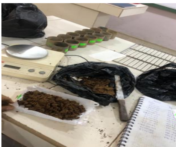
Figura 8. Determinación de Densidad Aparente.
