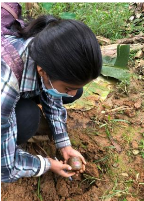
Figura 7. Toma de muestras para determinar Densidad Aparente.
