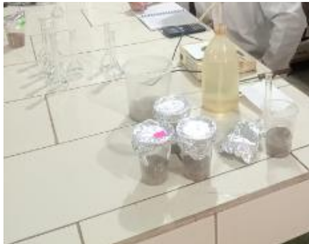
Figura 5. Determinación de Densidad Real
