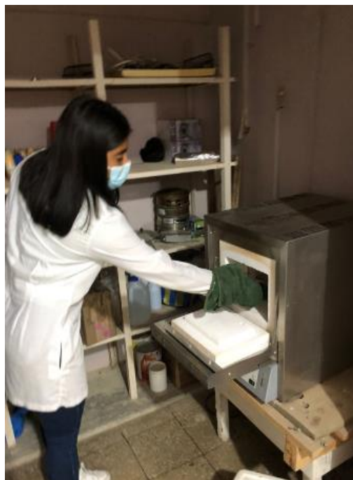
Figura 9. Muflado de muestras para determinar Materia orgánica
