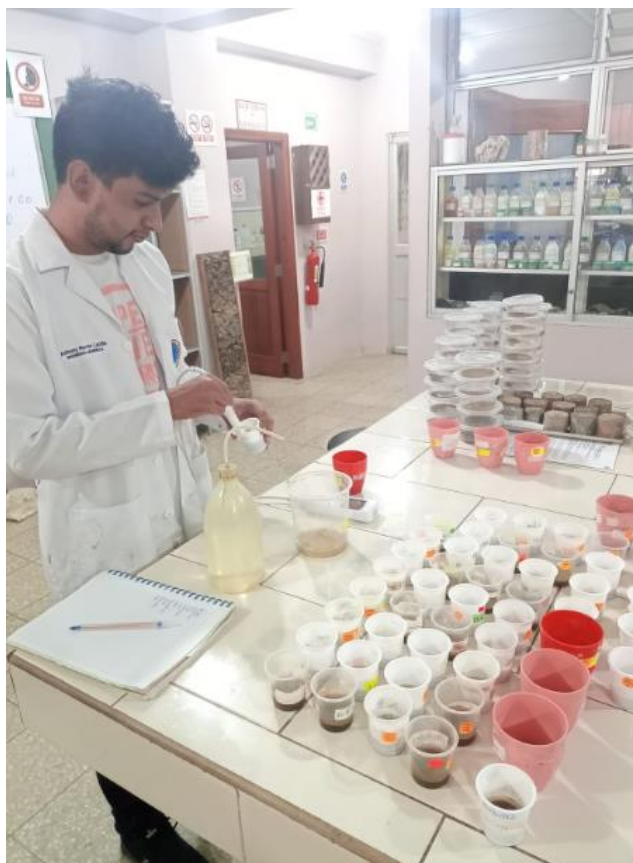
Figura 4. Toma de valores de pH
