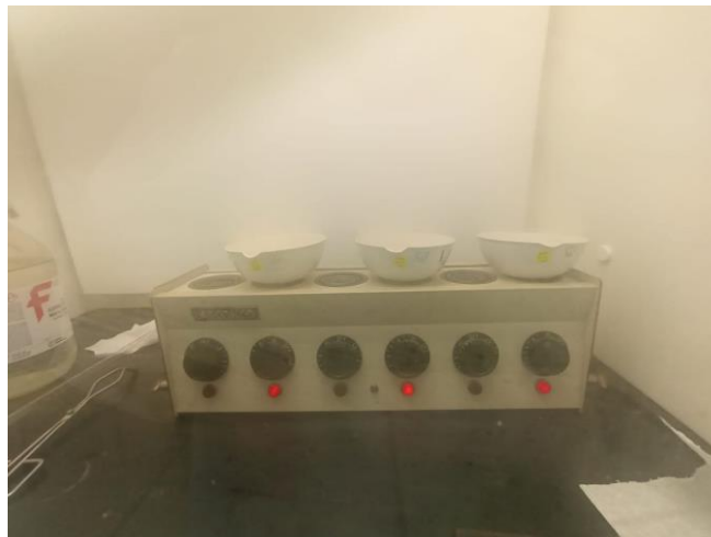
Anexo 14. Muestra en planchas de calentamiento con 10 ml de HNO 3 al 70% Fuente: Elaboración propia
