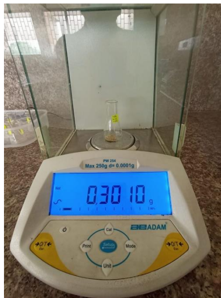
Anexo 12. Peso previo de la muestra para el proceso de digestión Fuente: Elaboración propia
