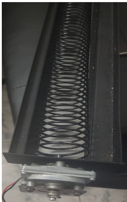
Ilustración 33: Transportador de tornillo sin fin. Fuente: Elaboración propia
