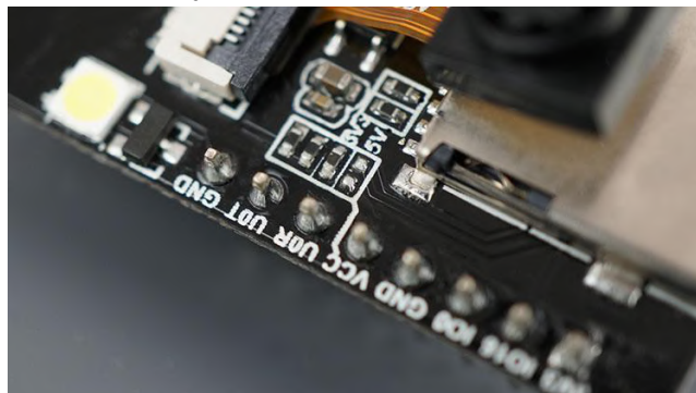
Ilustración 8: Almohadillas de conexión 3.3V o 5V
