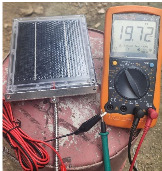
Ilustración 45: Pruebas de Voltaje al Panel Solar.
