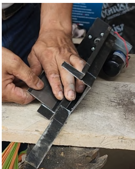
Ilustración 37: Proceso de Doblaje
