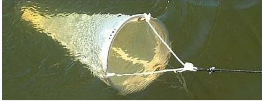
Figura 7: Red de plancton cónica realizando un arrastre
