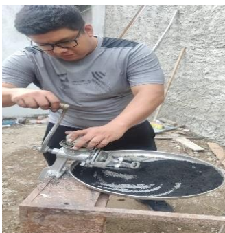
Figura 6. Producción de biocarbón: a) Ingreso de biomasa en el reactor; b) Biocarbón de cáscara de cacao y estiércol bovino; c) Triturado del biocarbón.
