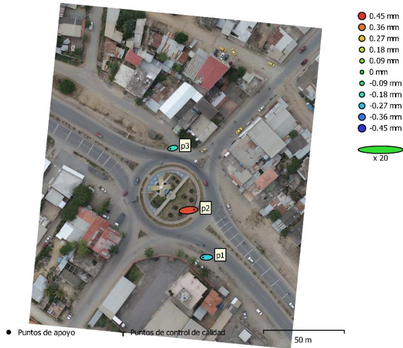
Fig. 4. Posiciones de puntos de apoyo y estimaciones de errores. El color indica el error en Z mientras el tamaño y forma de la elipse representan el error en XY. Las posiciones estimadas de puntos de apoyo se marcan con puntos o cruces.
