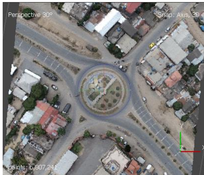
Figura 11 Nube de puntos densa generada en Agisoft. Fuente: Elaboración propia Dicha nube se debe depurar para limpiar la información que necesitamos, se clasifican los puntos por tipología, es decir, se omiten los puntos que pertenecen a vegetación, edificios, vehículos, etc., dejando lo concerniente a firmes de carretera, estructuras viales y terreno. Esto, para poder generar la superficie con el relieve dentro de Civil 3D. La nube se genera con formato “.las” y para poder trabajar con ella dentro de la suite de Autodesk se debe convertir a formato “.rcp”, para ellos se utiliza el software ReCap.
