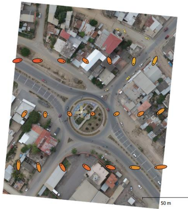
Figura 6 Posiciones de cámara del barrido fotográfico con dron. Fuente: Elaboración Propia
