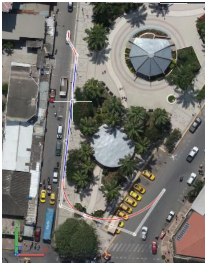
Figura 12: Alineamiento trazado en Civil3D. Fuente: Elaboración propia.
