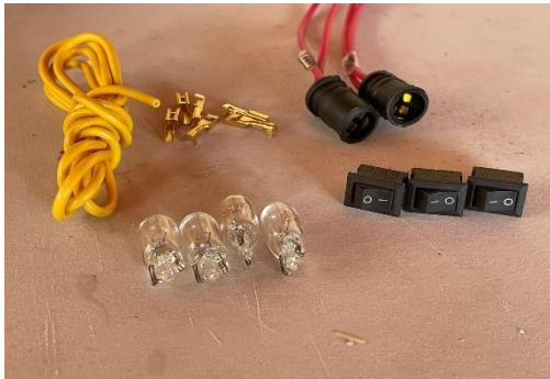
Imagen 61. Instalaciones Eléctricas (Focos, switch, socket, terminales, cables)
