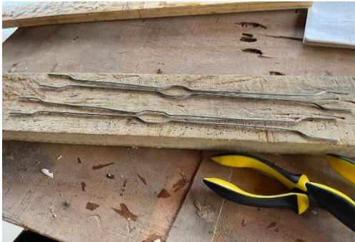
Imagen 21. Varillas de alambre # 14 para simular las vigas
