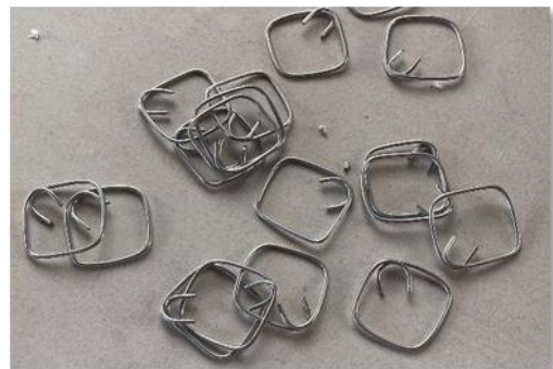
Imagen 4. Estribos de varilla #18
