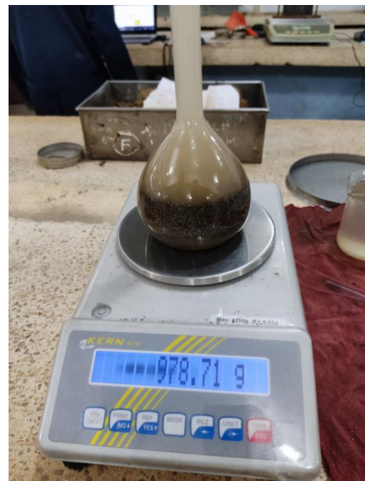
Peso de matraz + agua + muestra sss
