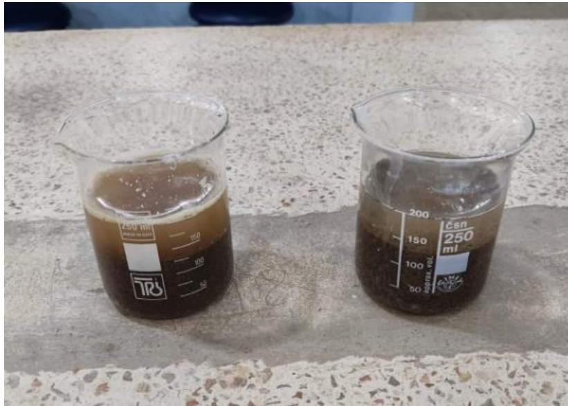
Muestras de 130 cm 3 de arena + la solución de agua con metasilicato de sodio
