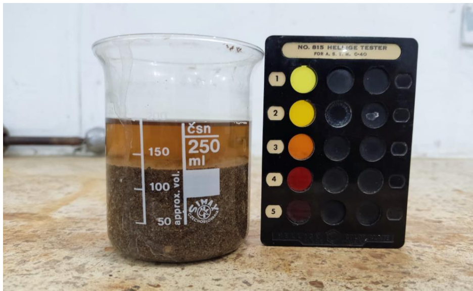
Muestra reposada por 24 horas junto con el comparador de colores normalizado
