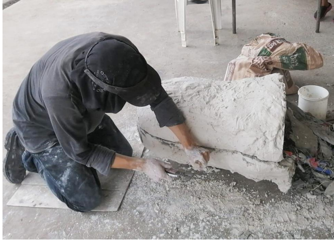
Figura 22. “Separación del molde de yeso” (2022) Fuente del autor. 15/01/2022
