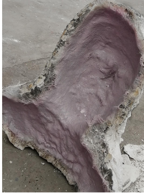
Figura 24. “Aplicación de Resina y fibra de vidrio sobre el molde” (2022) Fuente del autor. 15/01/2022
