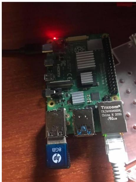
Figura 13: Instalación de Home Assistant - Conexión cable alimentación y ethernet
