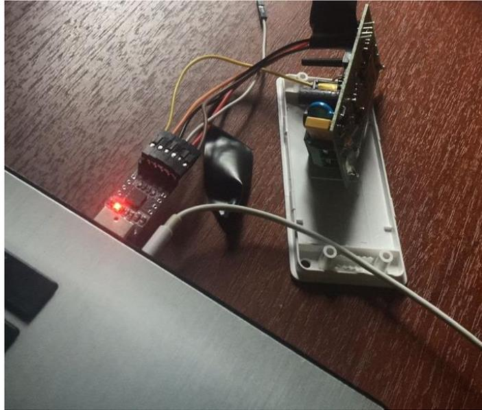
Figura 29: Instalación del firmware - Conversor y sonoff
