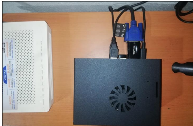
Figura 52. Conexión de jetson nano a router y dispositivos de E/S.
