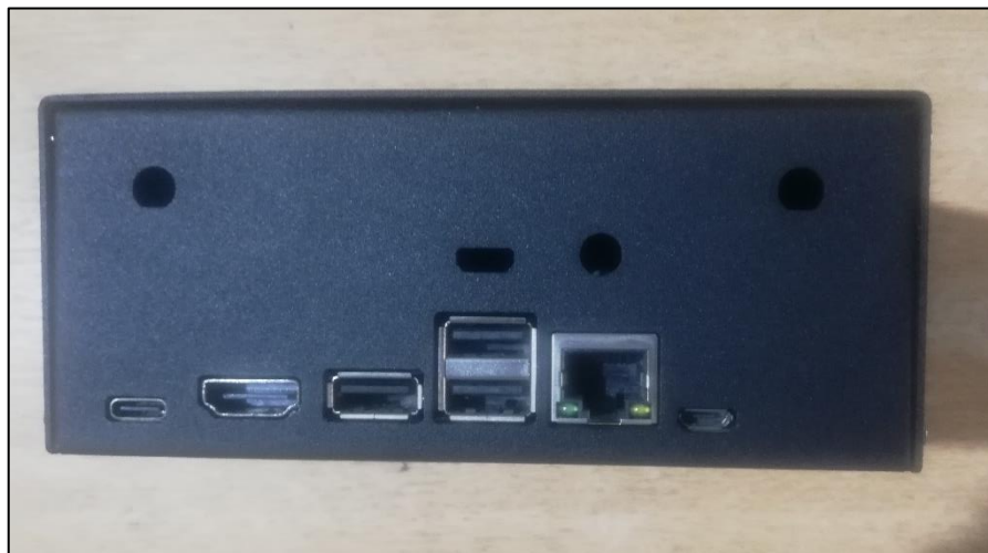
Figura 47. Vista de interfaces de entrada y salida de Jetson Nano en CASE
