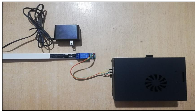
Figura 50. Conexión de pines relay y jetson nano.
