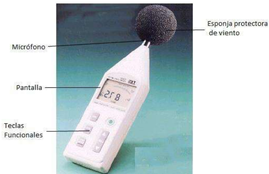
Figura 4 Partes del sonómetro
