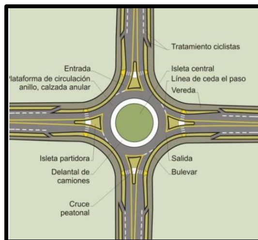
Figura. 3: Características de una rotonda típica
