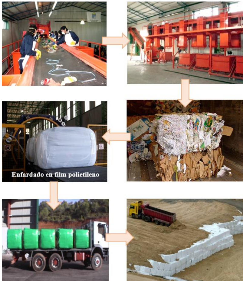
Figura 29 Proceso del sistema de enfardado de RSU
