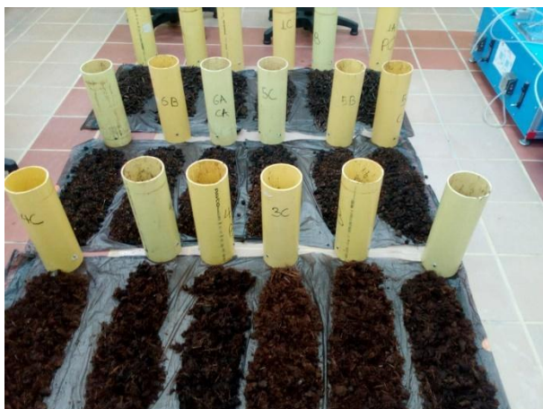
Figura 30 Biofiltro de composta
