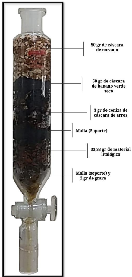
ANEXO 5 Segundo filtro compuesto por material litológico + cáscara de naranja + cáscara de banano verde + cenizas de cáscara de arroz ( ML+C_{bn}+C_{za} )
