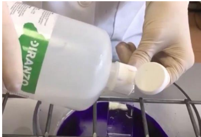
Figura 8. mezcla de alcohol y acetona como deshidratante
