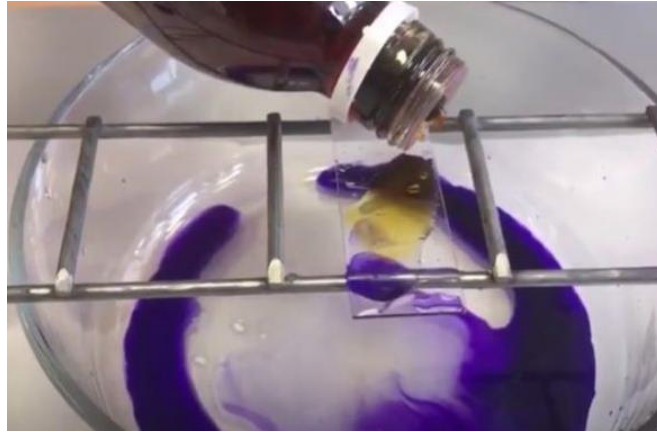
Figura 7. Aplicación de Lugol como fijador
