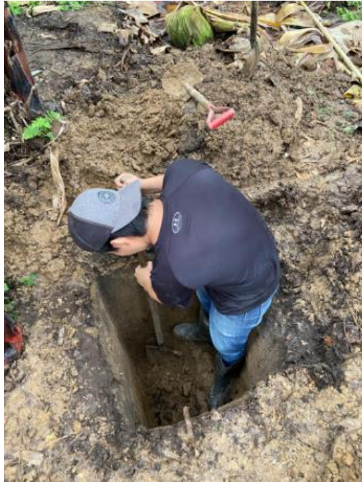
Anexo 1. Realización de calicatas
