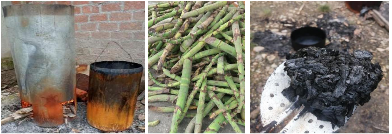
Anexo 1: Proceso de materia prima fresca hasta su descomposición y carbonización del raquis de banano.
