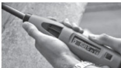
Ilustración 6: Uso del esclerómetro. Fuente: [16]
