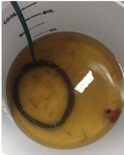
Figura 9. Forma del aireador de manguera microporosa. Fuente. Elaborado por Autor
