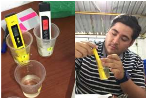
Figura 17. Toma de parámetro de pH y conductividad. Fuente. Elaborado por Autor
