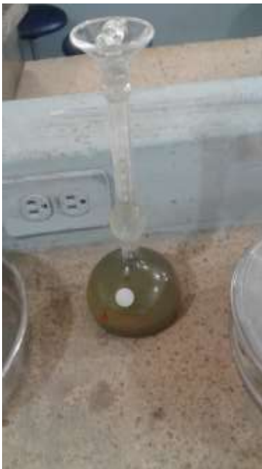
Colocación del cemento en el Chatelier.
