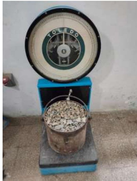
Peso del agregado grueso compactado.
