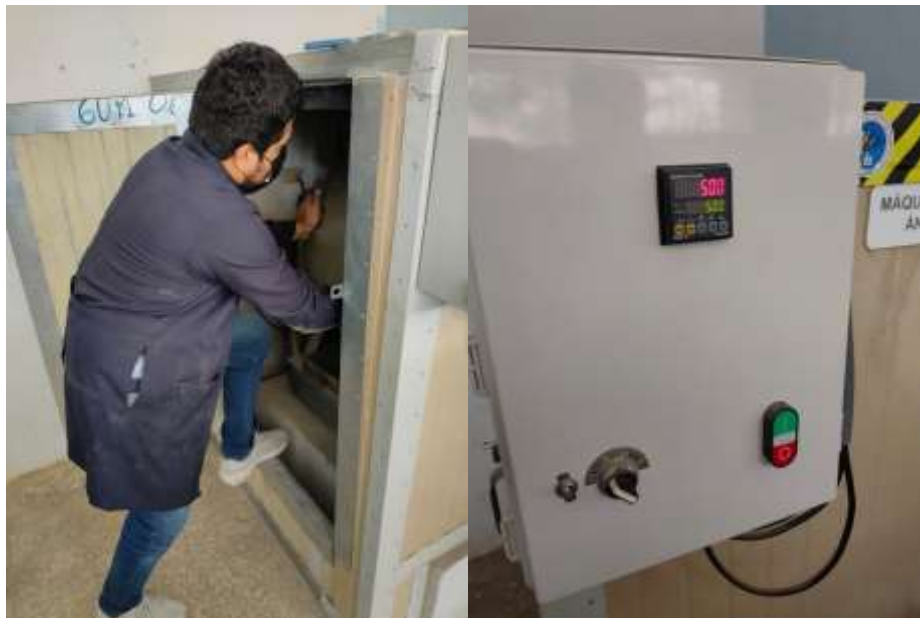
Utilización de la Máquina de los Ángeles.
