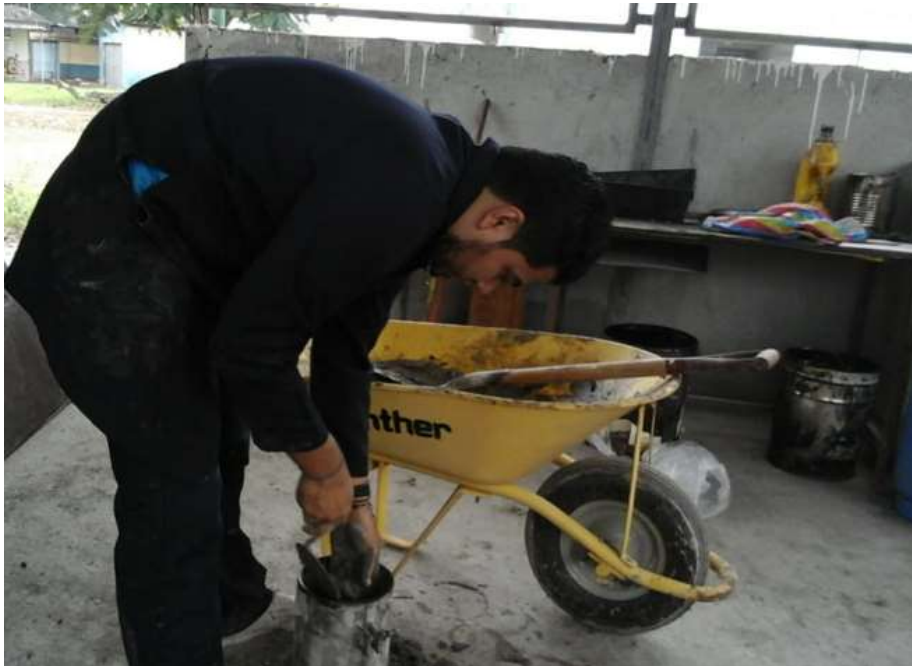
Colado de hormigón en las probetas.
