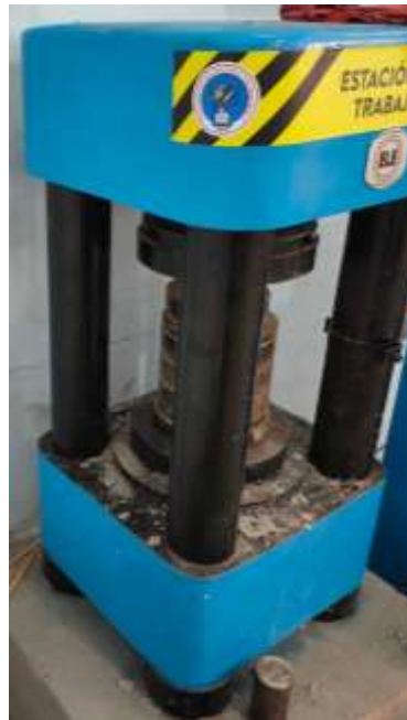
Rotura de cilindros
