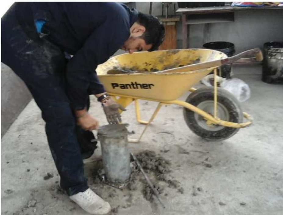
Enrasado del hormigón.
