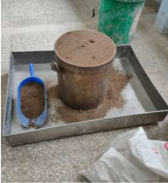
Enrasado del agregado fino.
