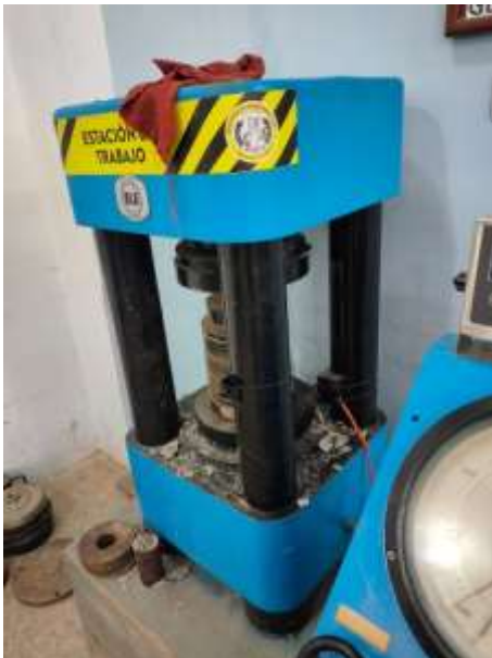
Máquina de rotura de cilindros de hormigón.
