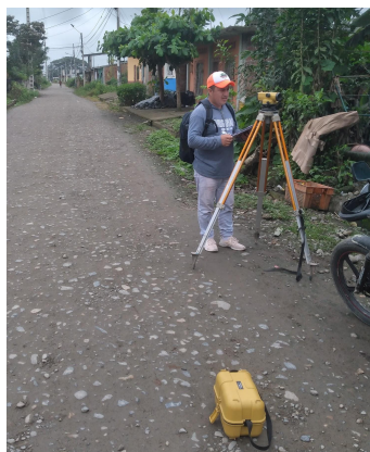
Ilustración 15. Nivelación geométrica del terreno. Fuente: Elaboración propia
