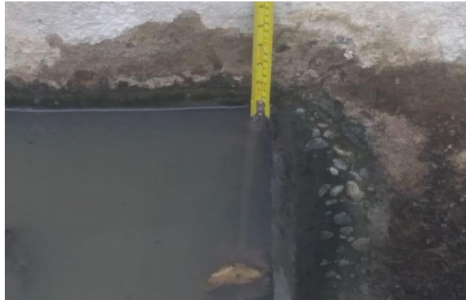
Ilustración 22. Vertedero rectangular sin contracción. Fuente: Elaboración propia
