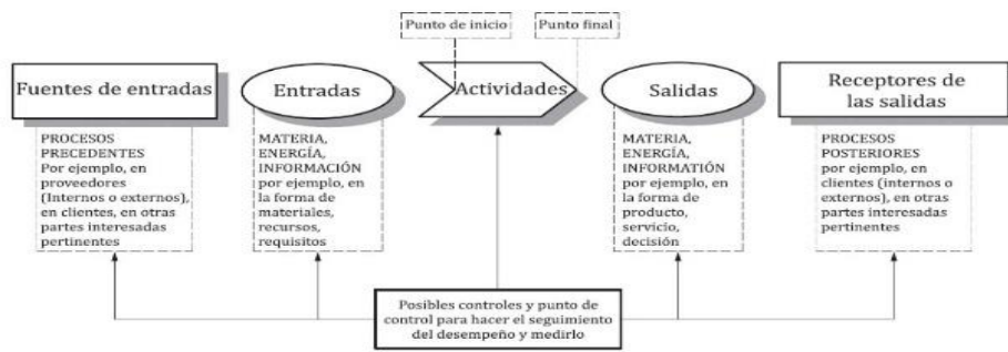
Fig. 2. Representación gráfica de los elementos de un proceso Fuente. ISO 9001:2015
