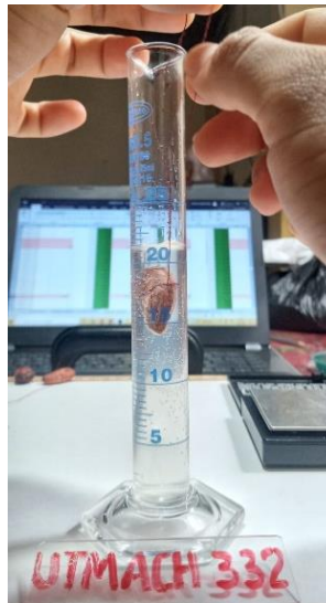
Figura 19. Grano sumergido en agua para tomar lectura del volumen desplazado Fuente: Autor.
