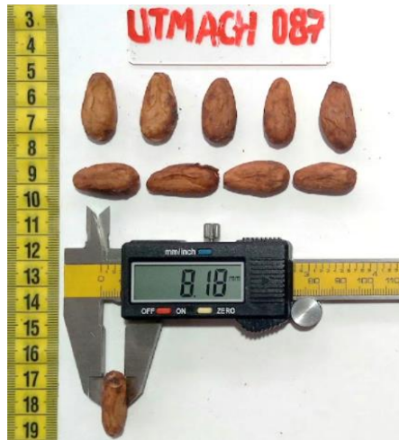
Figura 11. Medición del largo, ancho y espesor de las semillas con calibre pie de rey Fuente: Autor.
